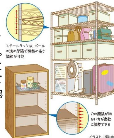
スチールラックは、ボールの溝の間隔で棚板の高さ調節が可能
