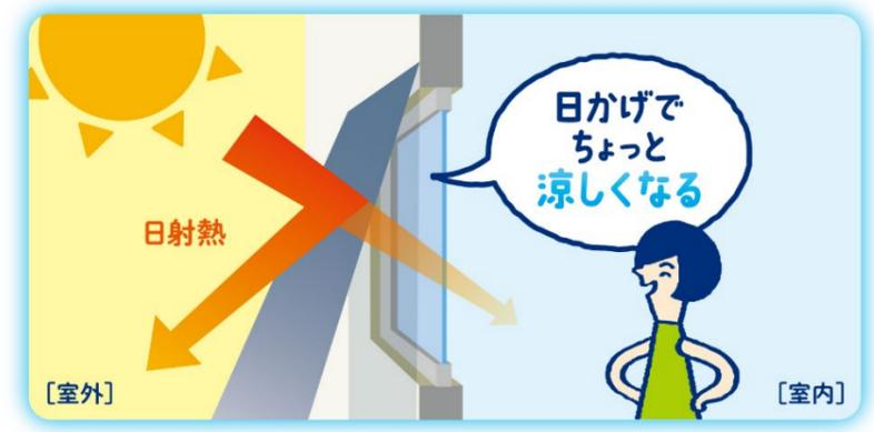
紫外線と同時に熱の流入も抑えるので、室内温度の上昇を防ぎます。また、日よけを室外に設置することで、室内に入る熱を効率的に抑えることができます。
